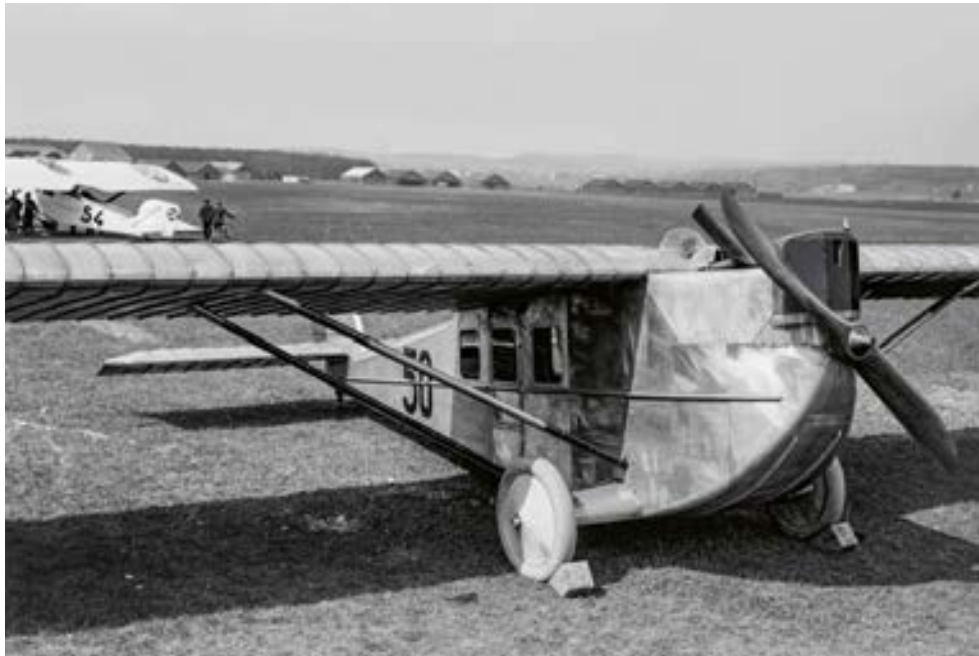
Im zweiten Dornier C III Komet II, hier bereits mit Schweizer Kennzeichen CH-50, bot der an der Vorderkante des Flügels angeordnete Pilotensitz bessere Sicht nach vorne. Foto ETH Bildarchiv
