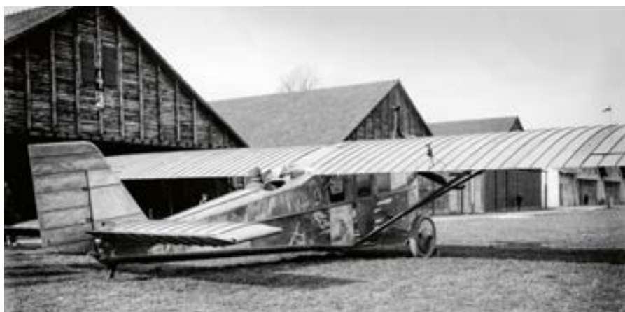
Der hinter dem Flügel angeordnete Pilotensitz wurde Ad Astra Pilot Max Cartier beim Einschulen auf dem Prototyp des Dornier C III Komet I CH-49 zum Verhängnis.
